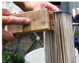
Faire faire un demi tour à vos filtres pour les retirer du spa. Les filtres cartouches de votre spa doivent être rincés chaque semaine. Utilisez un tuyau d'arrosage, et appliquer le jet d'eau avec un angle de 45 degrés, en veillant à déloger tout corps étranger par pulvérisation entre chaque pli. Une fois par mois, rincer les filtres avec le tuyau d'arrosage, brossez soigneusement la poussière et si nécessaire les faire tremper dans un composé de nettoyage
