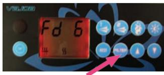
Appuyez sur "Filtre" pour entrer dans le menu cycle de filtration. Fd (filtration Durée): montre la durée en heures de la fonction: Vous pouvez définir minimum de 0 h, (La mode n'est pas actif) et de 12h max (le mode est toujours actif). Appuyez sur "FILTER" à nouveau.
