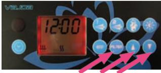
**F<sub>s</sub>** (filtration Start): affiche le temps de démarrage. Vous pouvez entrer l'heure à laquelle vous voulez le départ du mode filtration. Réglage et mise en place de cycle de filtration Réglage l'heure avec les touches UP / DOWN. Confirmer la valeur avec la touche FILTER.
