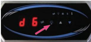
Appuyez longuement sur LIGHT (lumière) jusqu'à ce que **d** (durée) avec UP et DOWN régler la durée du cycle de filtration. Vous pouvez définir minimum de 0 h, (La mode n'est pas actif) et de 12h max (le mode est toujours actif). Appuyez sur LIGHT de nouveau.
